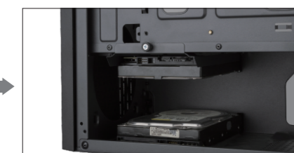
Put HDD on the bracket and fix it well / Coloque el disco duro en el soporte y fíjelo bien
