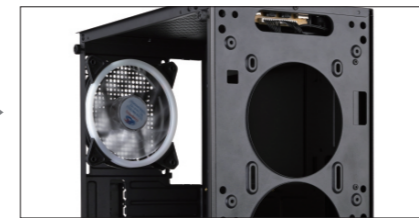
Put 120mm fan in fan location / Coloque un ventilador de 120 mm en la ubicación del ventilador
