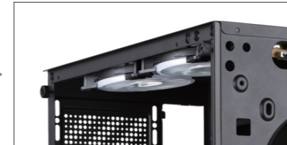
Put 2*120mm fans in fan location and fix it with screws / Coloque ventiladores de 2 * 120 mm en la ubicación del ventilador y fíjelo con tornillos
